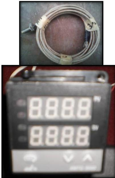
**Figura 29.** Termopar tipo J y transductor.
