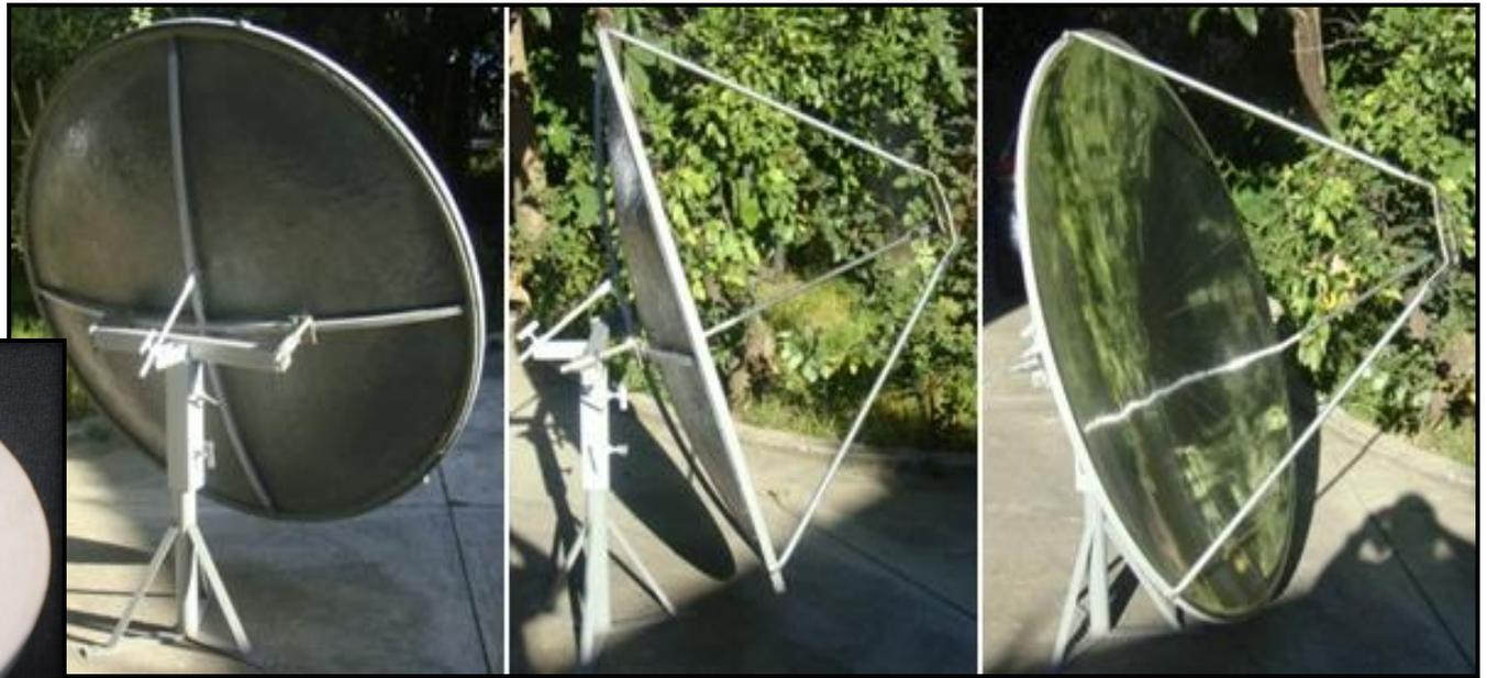
**Figura 18.** Disco parabólico manufacturado.
